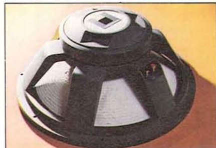
Il woofer della 4345 è il nuovissimo 2245H, dotato di bobina mobile da 100 mm, equipaggio mobile da 185 grammi e capace di sopportare ben 300 watt di potenza continua.
