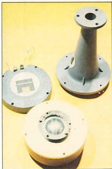
Il driver 2421 che riproduce le frequenze medio alte ha la bobina da 44 mm di diametro ed è accoppiato alla tromba 2307 tramite bocca da un pollice.
