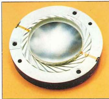
La membrana del 2421 è in alluminio con la sospensione dalle caratteristiche piegature a raggiera e la bobina in piattina di alluminio avvolta di taglio.
